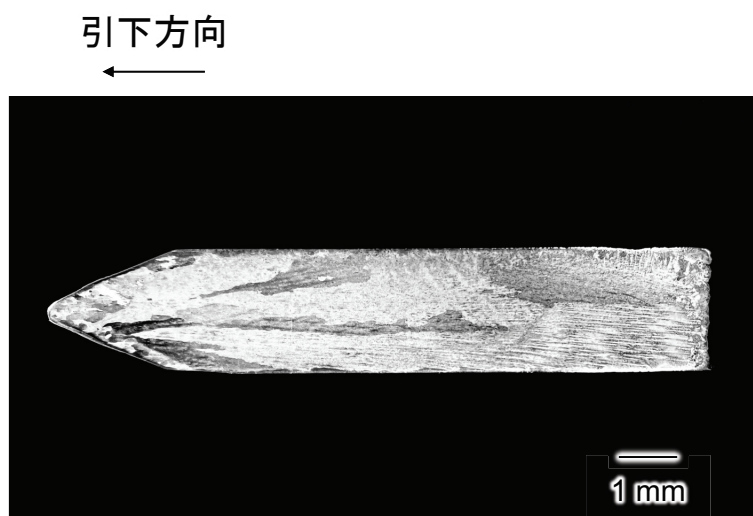
図 4.4 6061 アルミニウム合金の育成後のエッチング写真
