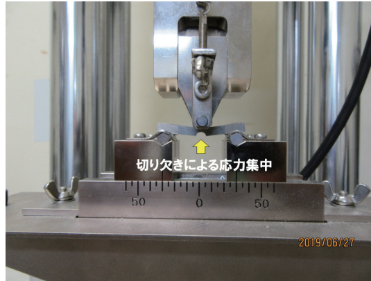
Fig. 5 無電解Ni-Pめっきを施した2017合金での三点曲げ試験の様子
